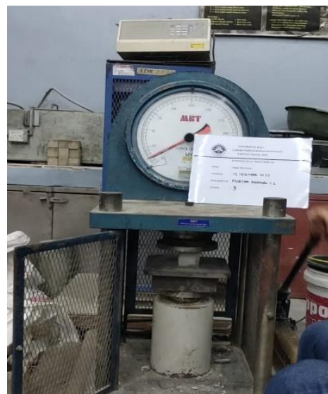
Gambar 4. Pengujian Kuat Tekan Mortar
