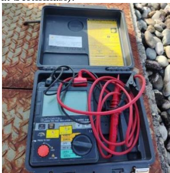
Gambar 3. 1 Alat Ukur Tahanan Isolasi Kyoritsu Model 3125
