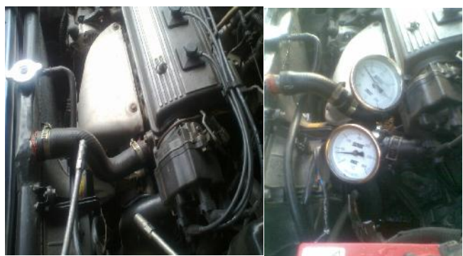
Gambar 2. Posisi pemasangan thermometer pada
