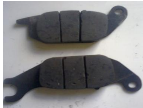
Gambar 1. Foto hasil finishing kanvas rem bahan komposit filler palm slag
