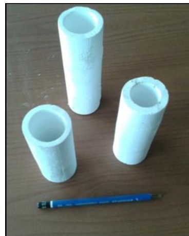
Gambar 6. Hasil pengecoran yang sudah dibakar pada 1350°C
