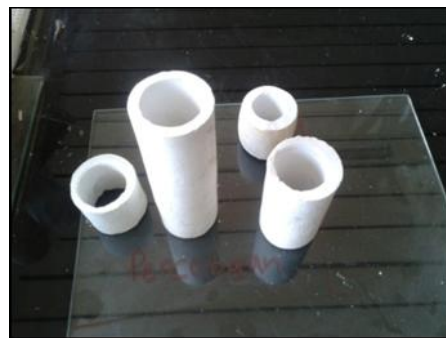
Gambar 6. Hasil pengecoran setelah dikeringkan
