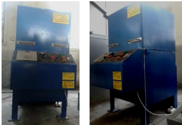
Gambar 4. Mesin centrifugal casting hasil rancangan.
