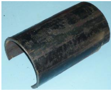
Gambar 1. Sampel Tube Heater yang digunakan untuk pemeriksaan struktur mikro, analisa komposisi kimia, uji kekerasan, uji tarik dan pengujian creep.
