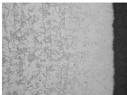
Gambar 6. Struktur mikro potongan melintang Tube Heater dibagian dalam berupa ferit (putih) dan perlit (hitam). Perbesaran : 200X. Etsa :Nital 2%.
