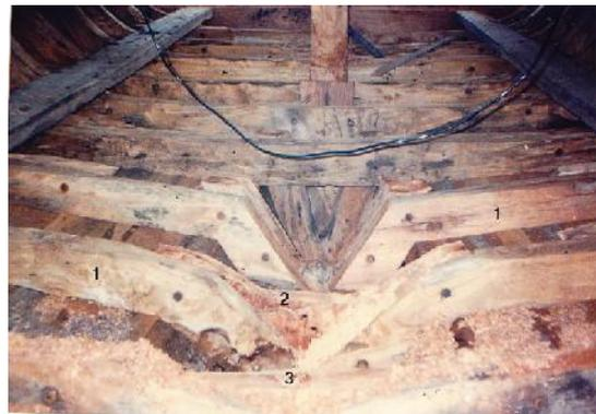
**Gambar 1. Foto Konstruksi Casco Kapal Trammel Net [3]**
