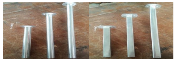
Gambar 3. Model Fondasi Sumuran Bentuk Lingkaran dan Bujur Sangkar ukuran 2,5 cm, tebal 5 mm dengan panjang 30cm, 45 cm, 60 cm
