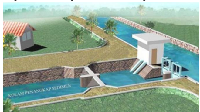
Gambar 8 Kolam Retensi tipe storage memanjang
