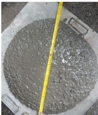
Gambar 1. Pengujian Slump Flow
