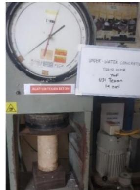
Gambar 2. Pengujian kuat tekan beton
