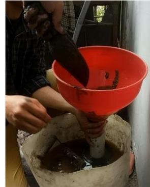
Gambar 1. Pengecoran beton ke dalam air
