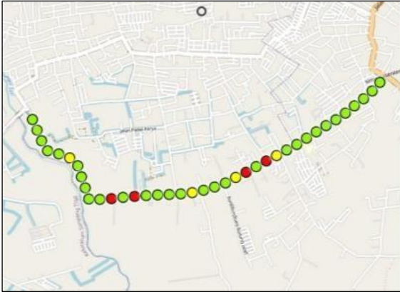
Gambar 4.3 Peta Kondisi Permukaan Jalan Pesantren STA 00+000 - 03+800 (Sumber: Roadroid , 2024)
