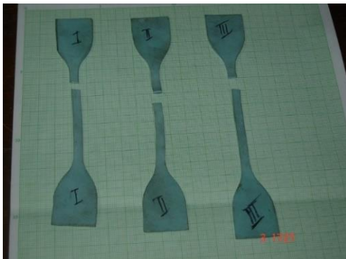
Gambar 3.3 Patahan Spesiemen Uji Tarik
