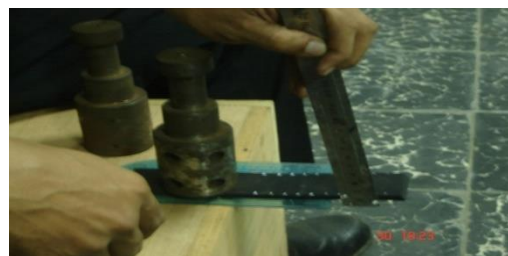
Gambar 3.5 Pengujian Kelenturan Karet Strip
