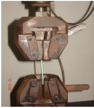
Gambar 2.5 Pemasangan Spesiemen Uji Material Karet (mm)
