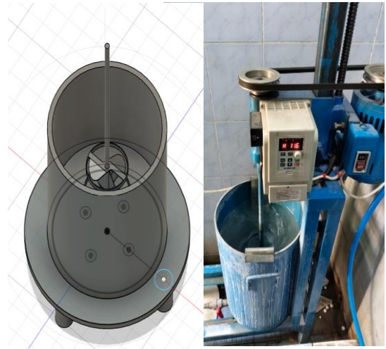
Gambar 3. Alat Uji Abrasi Underwater ASTM C1138 (sumber dokumentasi sendiri)
