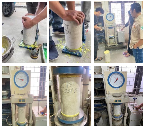
Gambar 4. Pengujian Kuat tekan Beton
