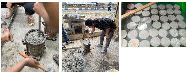
Gambar 3. Pembuatan Benda Uji Silinder
