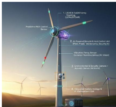
Gambar 2. Contoh desain inovasi turbin angin berbasis sensor dan ai.
