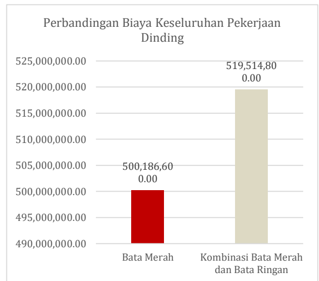
Gambar 4.3 Grafik perbandingan biaya keseluruhan pekerjaan dinding
