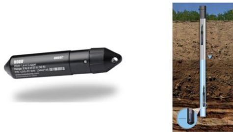
Gambar 2 Alat water level logger dan ilustrasi pemasangan alat pada sumur pantau (Sumber : Loggerindo, 2025)
