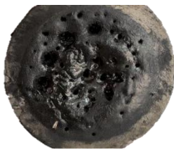
Gambar 8. Tampak Atas Sampel Pasta Geopolimer Abu Sawit Setelah Dilakukan Pengujian
