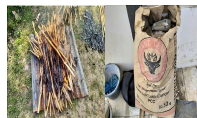
Gambar 3. Bahan Stabilisasi Abu Batang Jagung dan Semen
