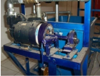
Gambar 2. Pompa yang akan diuji
