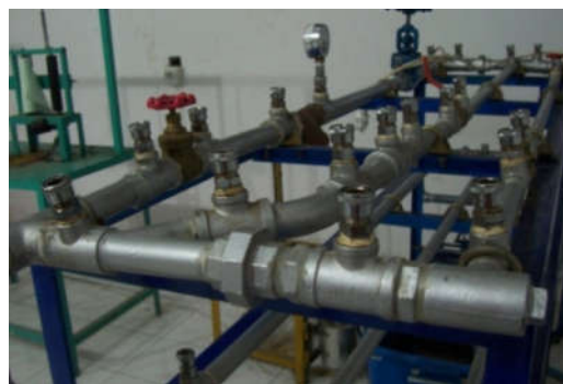
Gambar 1. Alat Uji rugi-rugi aliran
