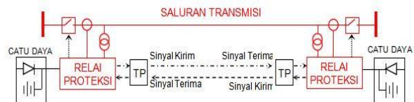
Gambar 2.2 Komponen sistem proteksi SUTT [2]
