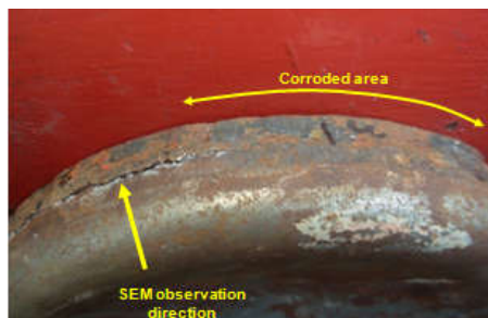
Gambar 7. Daerah yang terkorosi dan arah pengamatan SEM
