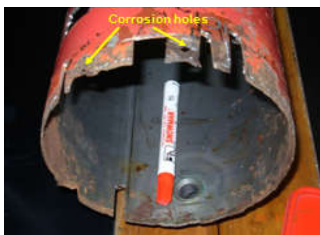
Gambar 4. Detail kerusakan dinding APAR
