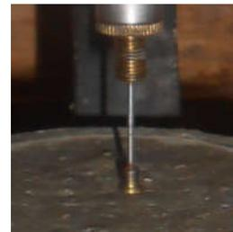
Gambar 4. Jarum Vicat untuk pengujian waktu ikat akhir
