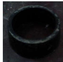
Gambar 5. Cetakan benda uji (cincin ebonit)
