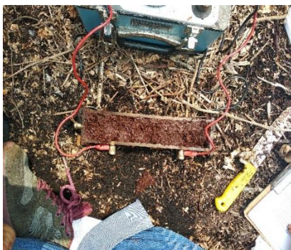
Gambar 3. Pengujian Geolistrik di Lapangan
